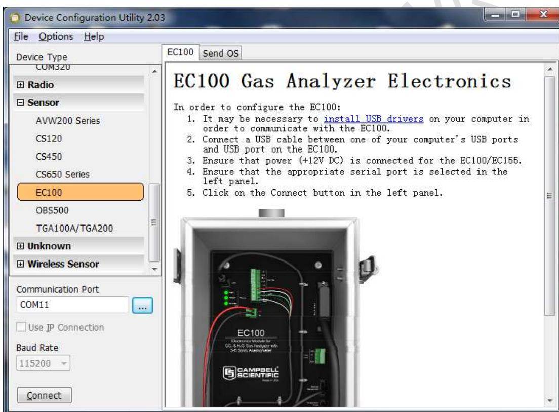
在 Device Type 里面选择 EC100, 在 Communication Port 里面选择电脑分配的 COM 口, 点击 OK, 完成之后连接 Connect。
