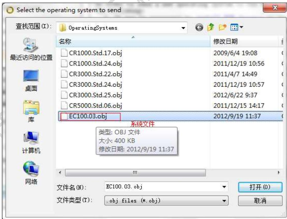
然后点击打开，会弹出系统导入的进度，下面的过程让仪器自动完成。
