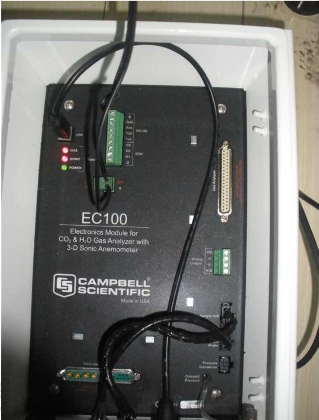
3. 使用 EC100 机箱自带的 USB 线连接 EC100 机箱到电脑，一端连接 EC100 机箱，一端连接电脑，连接方法如下：
