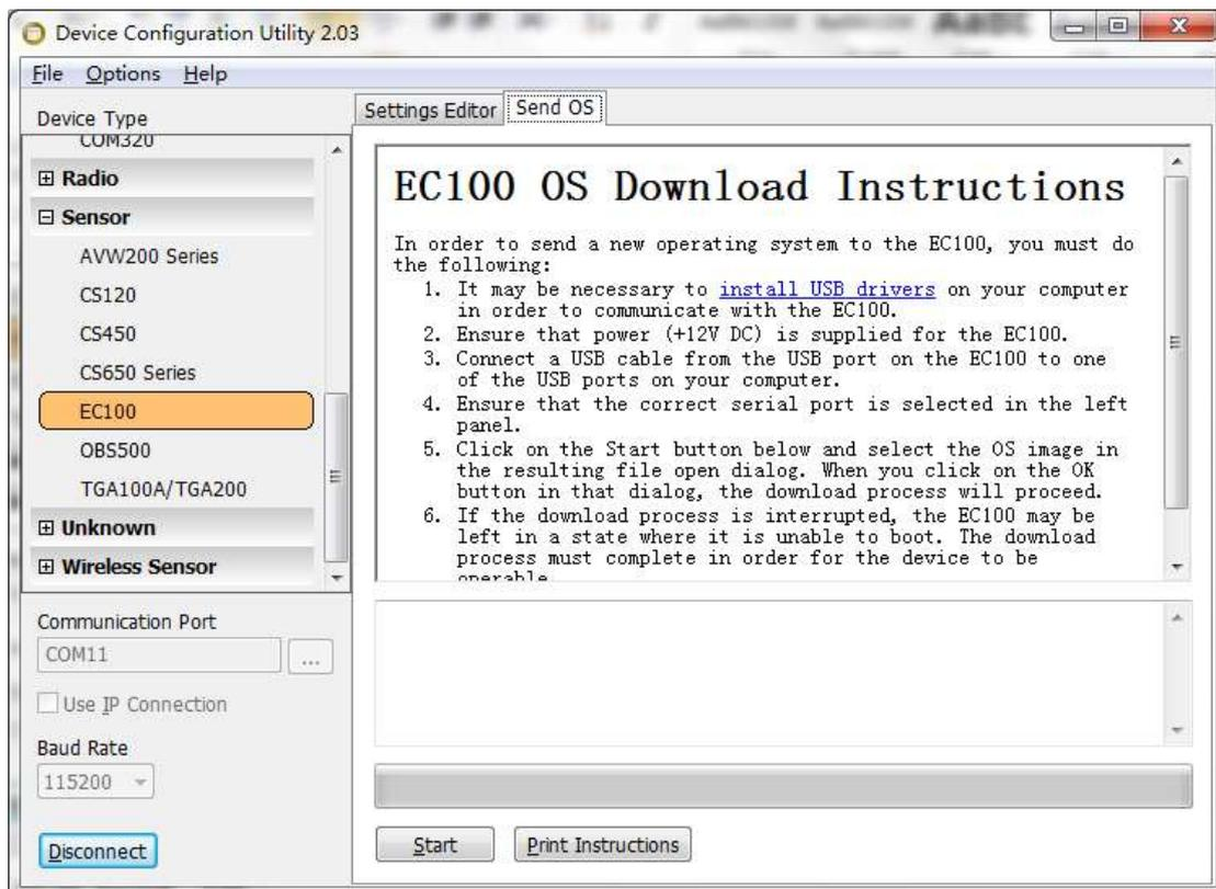
7. 按照对话框里面的步骤确保前面的操作没有问题，确认后点击 Start，在弹出的对话框里面找到前面安装完成后生成的系统文件。
