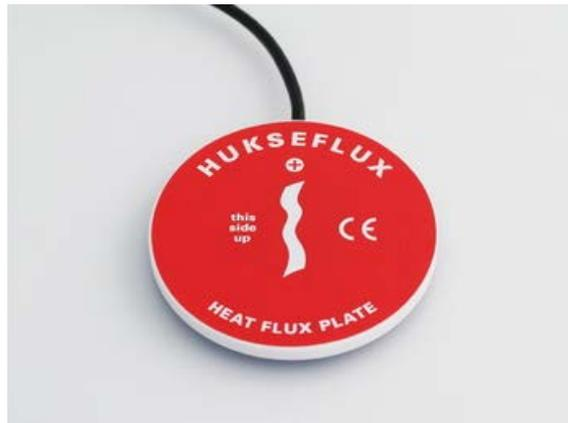
Hukseflux HFP01 热通量传感器可用于测量土壤、墙体或其他建筑物内部的热通量，它已在世界范围内得到广泛使用，尤其适用于能量平衡研究和波文比系统。传感器外壳采用陶瓷-塑胶材料，内含一个热电堆。传感器通过感应热通量板上下温差产生电压信号，结合介质热传导率对热通量进行测量，并以。HFP01 使用简便，只需配备一只精准的毫伏级电压表即可。
