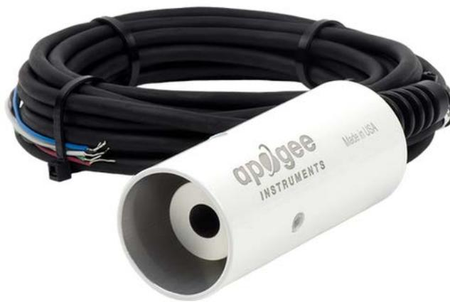
SI-111（原型号 IRR-P）是 CSI 采用 Apogee 公司的红外探头制造的一种高精度的红外温度传感器，采用光学锗透镜，基于红外测温原理，可以在野外条件下进行不间断测量。SI-111 由一个热电堆（用来测量表面温度）和一个热敏电阻（用来测量传感器自身温度）构成，两种温度探头都被放置在一个铝制导管内。热电堆和热敏电阻输出的都是毫伏电压信号。该传感器通过 CSI 出品的 CR 系列数据采集器来收集观测数据，并通过公式进行温度修正，以获得更加准确的温度数据。
