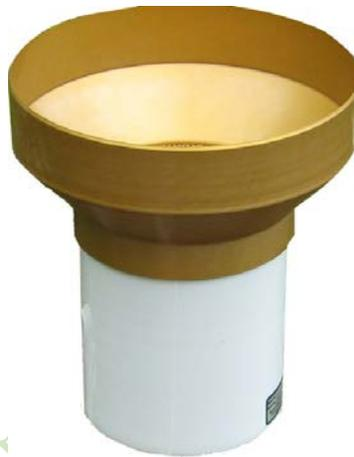
Campbell TE525MM 系列翻斗式雨量筒（Texas Electronics 制造）可测量 0.1mm 的降水增量。雨量筒通过翻斗来测量降雨量，降雨通过漏斗进入机械式翻斗，当翻斗充满到标定线时自动倾斜倒掉雨水，从而通过翻斗的反转次数来测量降雨量。该产品可与 Campbell 出品的数据采集器连接。用户可以根据实际需要来定制线缆长度。
