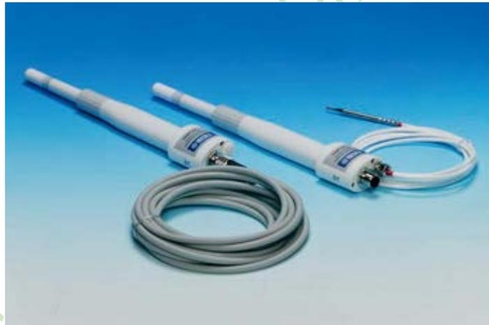
HMP155A 是一款性能优异的温度相对湿度传感器。它采用 Vaisala 最新研制的具有专利技术的 HUMICAP®180R 加热型相对湿度探头, 并结合当前先进的制造工艺, 具有卓越的稳定性和强大的环境适应能力。凭借其灵敏度更高、反应更加迅速的新型温度探头, HMP155A 能够以更快的速度对环境温度的变化做出反应, 让您随时掌握温度变化的第一手数据资料。HMP155A 支持  $0\sim 1\text{V}$  电压输出, 对 CSI 的全系列数据采集器拥有良好的兼容性; 其采用节能设计, 仅在测量时由数据采集器供电, 非工作时可停止供电。
