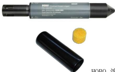
HOB0 溶解氧记录仪是使用 RDO® 基本技术测量溶解氧 (DO) 的独立记录仪。记录仪有一个光学传感器, 可提供 0.2 mg/L 的精度。该记录器还具有一个易于更换的传感器盖和一个集成的温度传感器。使用 HOB0ware® 软件进行记录器设置和 HOB0 Waterproof Shuttle 用于快速数据卸载, 该记录器易于部署在淡水和咸水环境中, 使其成为环境影响研究以及生态和海洋学研究的理想工具。使用从记录器中卸载的数据, HOB0ware 溶解氧助手可以计算饱和度百分比和盐度调整的 DO 浓度, 并纠正因污垢引起的测量漂移 (需要额外的仪表或记录器测量)。
