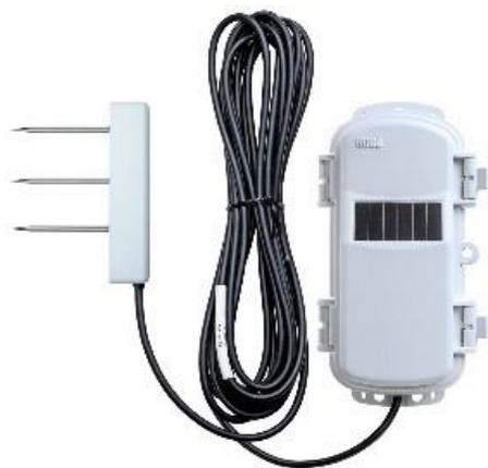
该传感器可测量多种土壤类型中的土壤湿度、温度和电导率 (EC)，包括高盐度土壤和沙质土壤。它旨在与 HOBOnet (HOBOnet® RX) 无线传感器网络一起使用，其中数据从传感器节点通过网络无线传输到站点，然后上传到基于网络的 HOBOLink® 软件。使用 HOBOLink，您可以监控传感器读数、查看图表、设置警报、下载数据等。
